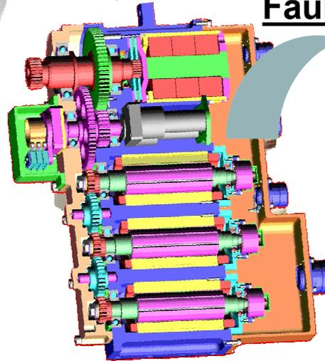
**Triplex Redundant Actuator**
